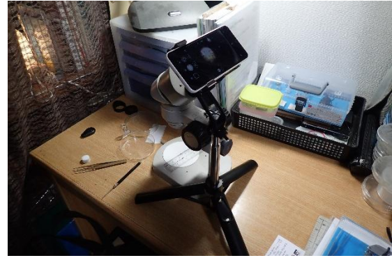
図2 双眼実体顕微鏡、スマホ、自撮り棒を使用した頭殻撮影装置
